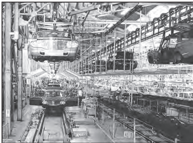
चित्र 5.4 : जापान में एक मोटर निर्माण कंपनी के कारखाने में यात्री कार की संयोजन प्रक्रिया
